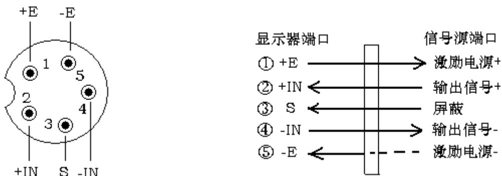
图 4b: 传感器与五芯航空针连线图
